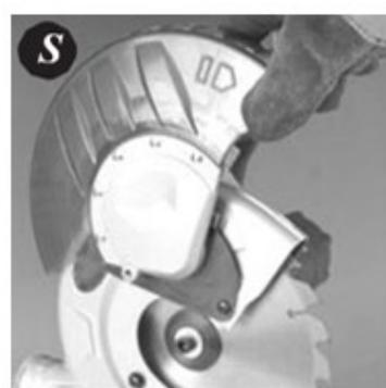
7. Segure a proteção rotativa (5) para cima e pressione o botão de travamento do eixo (18). Gire a lâmina até o eixo travar (fig. T).
